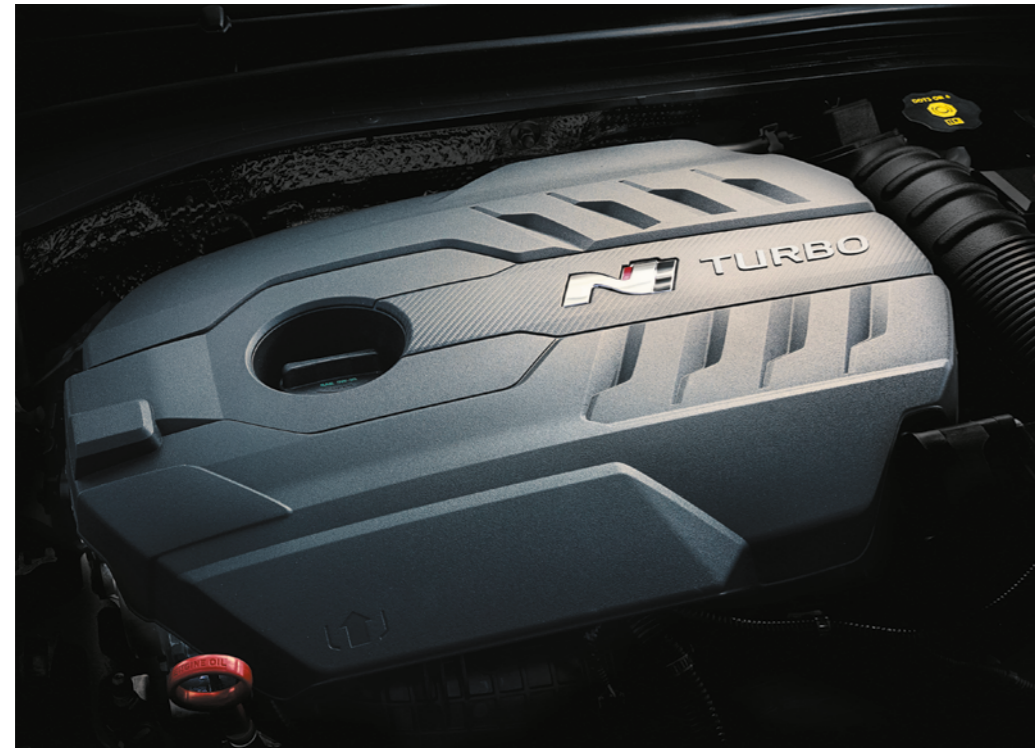
Новый турбированный двигатель рабочим объёмом 2 литра с системой прямого впрыска мощностью 249 л.с. или 275 л.с.
